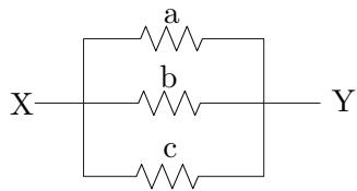
Admita que a sequência (a, b, c) é uma progressão geométrica de razão  $\frac{1}{2}$  e que a resistência equivalente entre X e Y mede  $2,0 \Omega$ . O valor, em ohms, de  $(a + b + c)$  é igual a:
