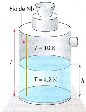
No gráfico, pode-se observar que a resistividade apresenta uma queda brusca em  $T = 9,0$  K, tornando-se nula abaixo dessa temperatura. Esse comportamento é característico de um material supercondutor. Um fio de Nb de comprimento total  $L = 1,5$  m e seção transversal de área  $A = 0,050\text{ mm}^2$  é esticado verticalmente do topo até o fundo de um tanque de hélio líquido, a fim
