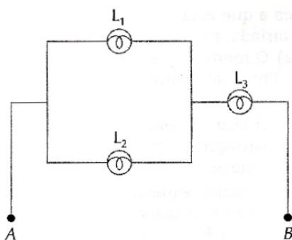
Entre os terminais  $A$  e  $B$  aplica-se a ddp de 12 V. A intensidade de corrente elétrica que passa pela lâmpada  $L_3$  é:
