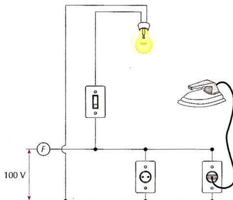
A potência máxima de um ferro de passar roupa, que pode ser ligado, simultaneamente, a uma lâmpada de 150 W, sem que o fusível interrompa o circuito, é aproximadamente de:
