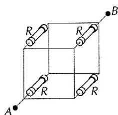
Aplicando entre os pontos  $A$  e  $B$  uma diferença de potencial  $V$ , a corrente que circulará entre  $A$  e  $B$  vale:
